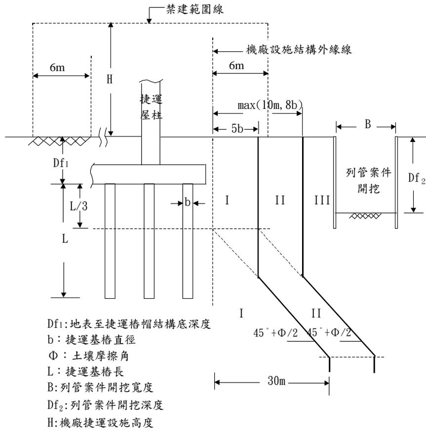
圖五 列管案件為明挖工程之分級規範界線圖
