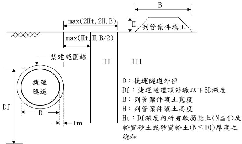
圖十五 列管案件為填土工程之分級規範界線圖
