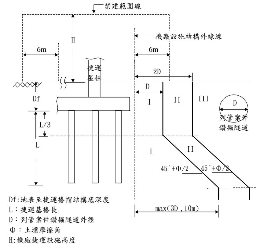
圖十三 列管案件為鑽掘隧道之分級規範界線圖
