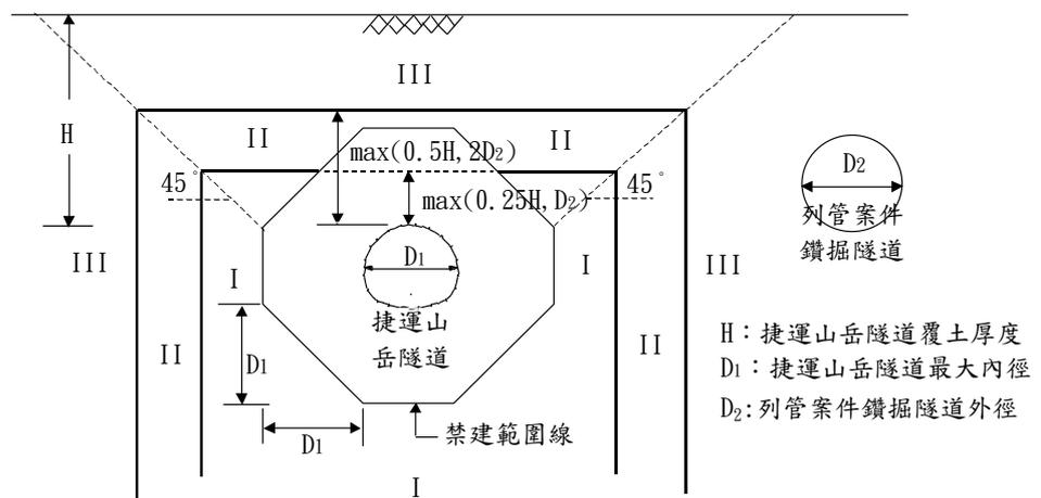
圖十四 列管案件為鑽掘隧道之分級規範界線圖
