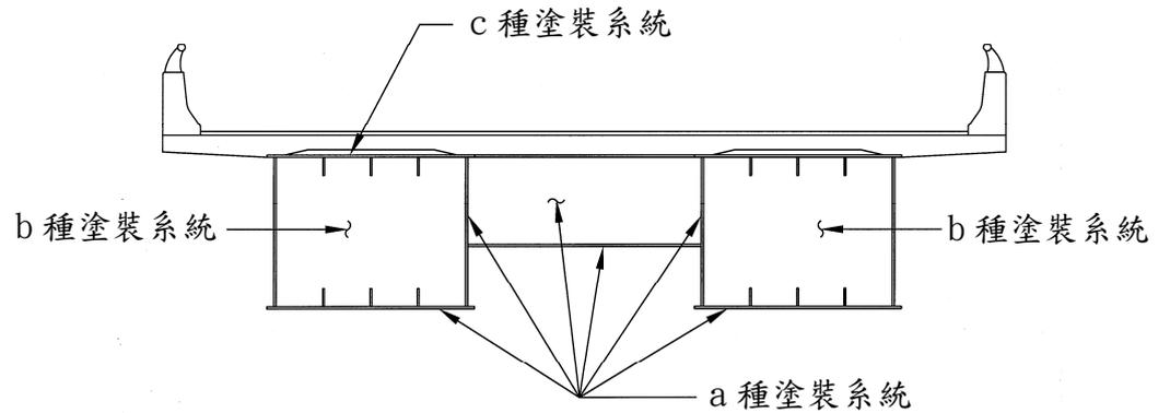
圖 09972-2 鋼箱型梁橋塗裝示意
