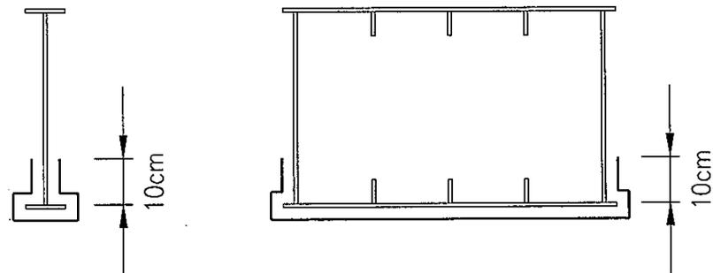
圖 09972-3 鋼橋外露面塗裝系統增塗底漆範圍示意圖
