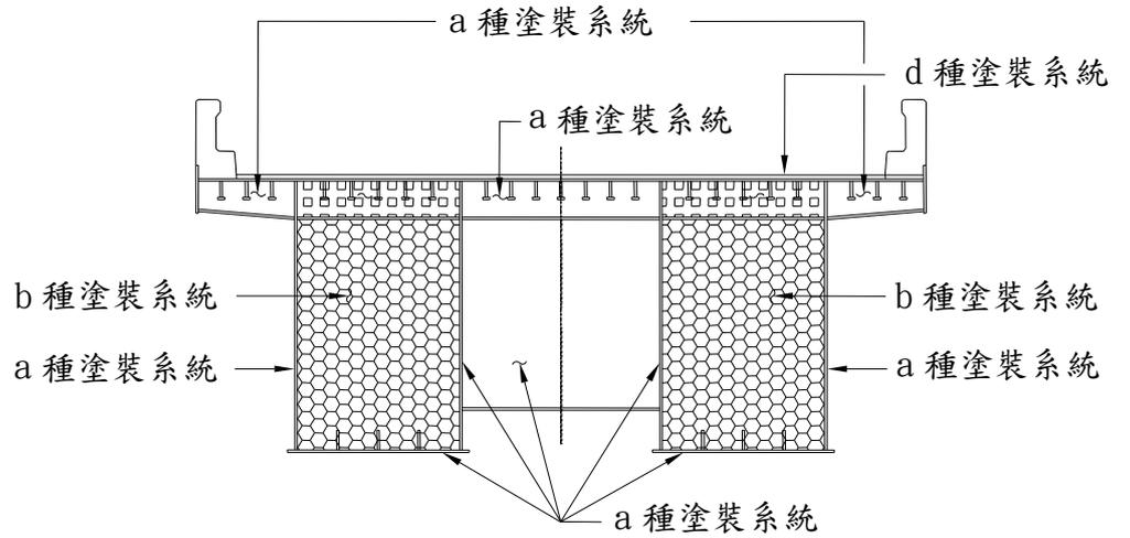
圖 09972-1 鋼橋面板橋塗裝示意
