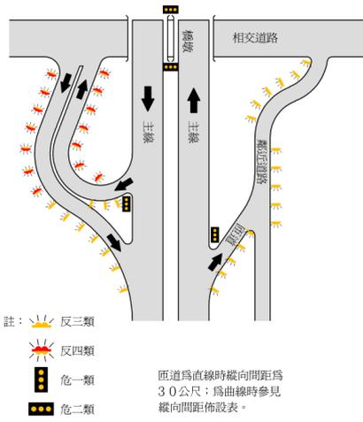
圖五 雙向車道有緣石之狹橋上反光導標及危險標記之設置
