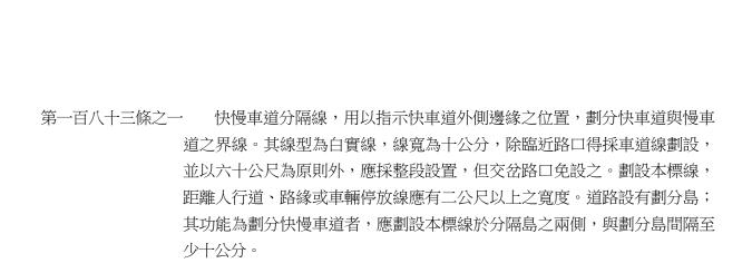
本標線得視需要於慢車道由左至右併排繪設機車圖案及自行車圖案,每過交岔路口入口處標繪之,路段中每超過五百公尺得加繪一組。
