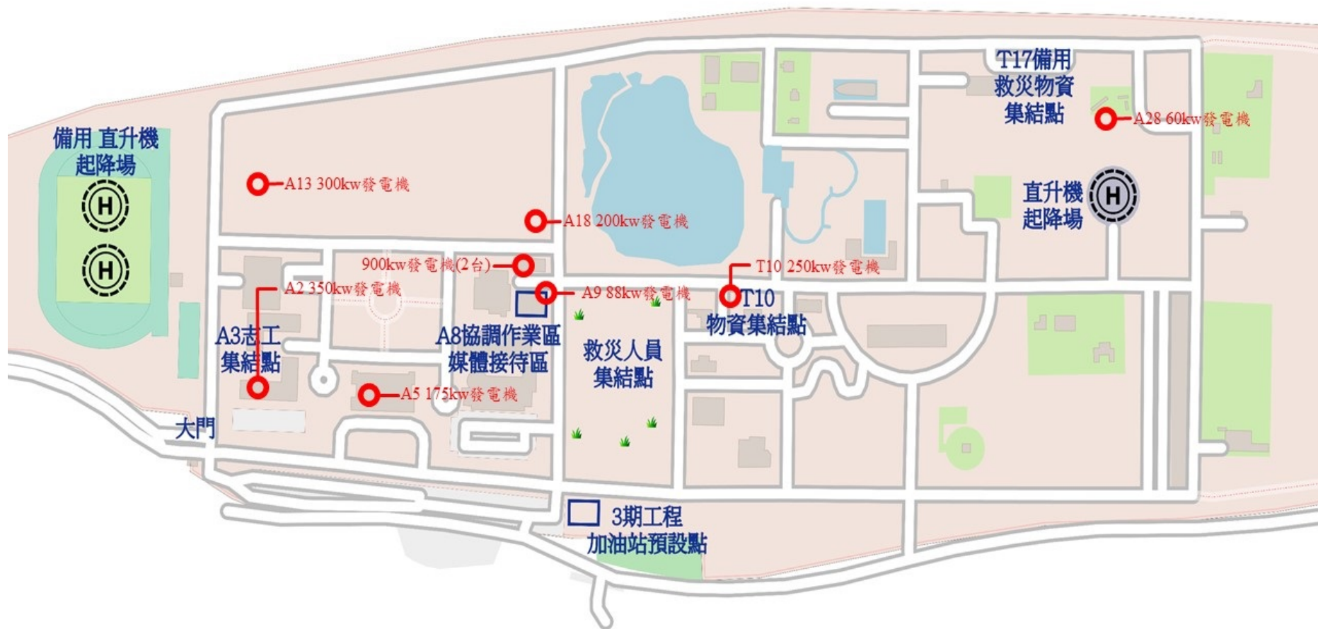
附圖七 訓練中心緊急發電機分佈圖
