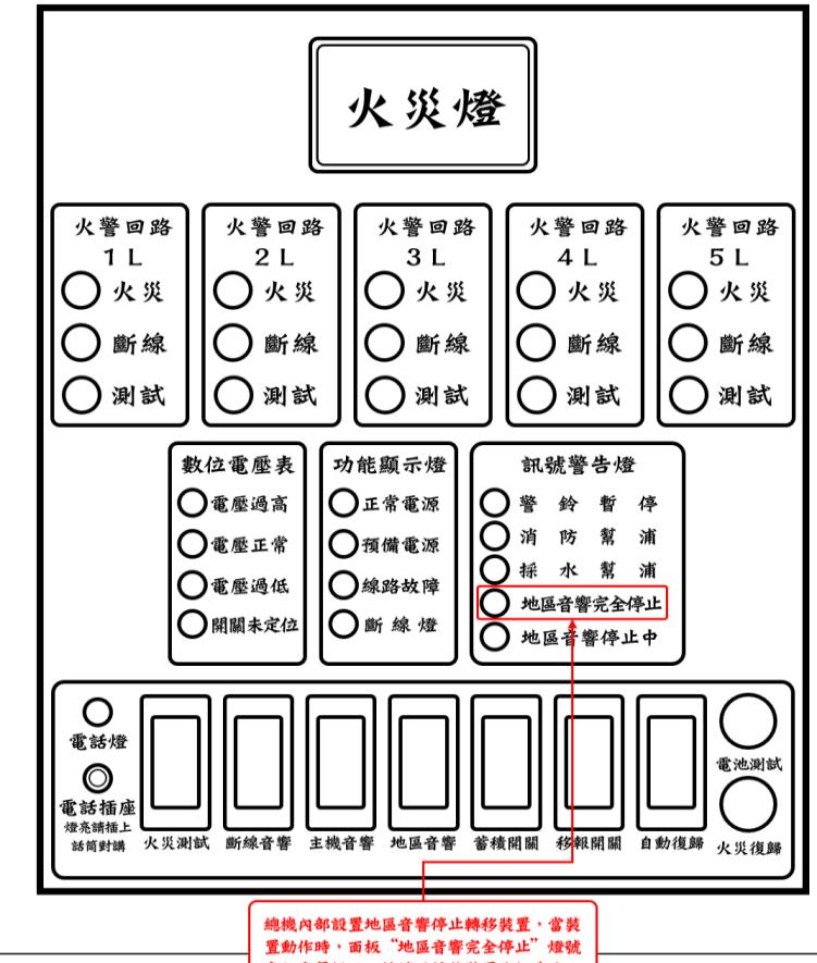
示意圖八 操作面板（當維修時，開啟地區音響轉移裝置，地區音響完全停止燈亮起，並響起警示音）
