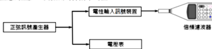
圖 4 倍頻濾波器過載指示檢測系統圖
