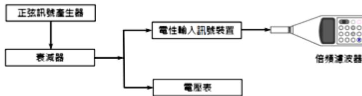
圖 2 倍頻濾波器位準線性度檢測系統圖
