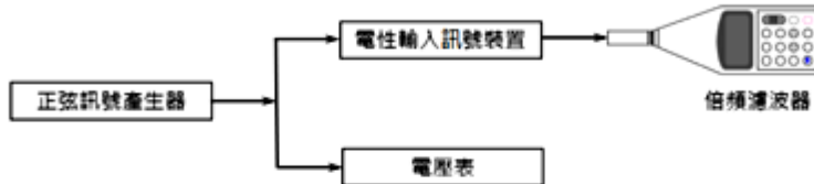
圖 1 倍頻濾波器平坦頻率響應檢測系統圖
