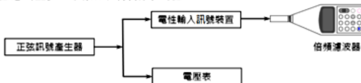
圖 3 倍頻濾波器相對衰減檢測系統圖
