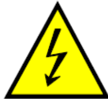
圖一：高電壓裝備之標識
