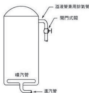
圖七 排氣口裝置例五
