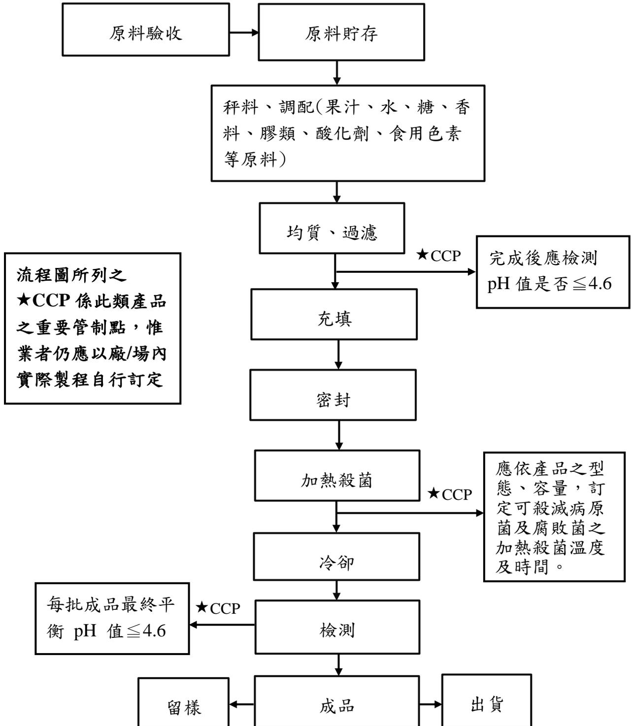
圖二、果凍類產品製造加工參考流程圖
