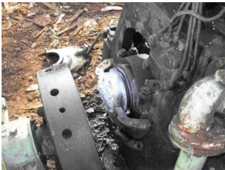
副機引擎曲軸切斷後
