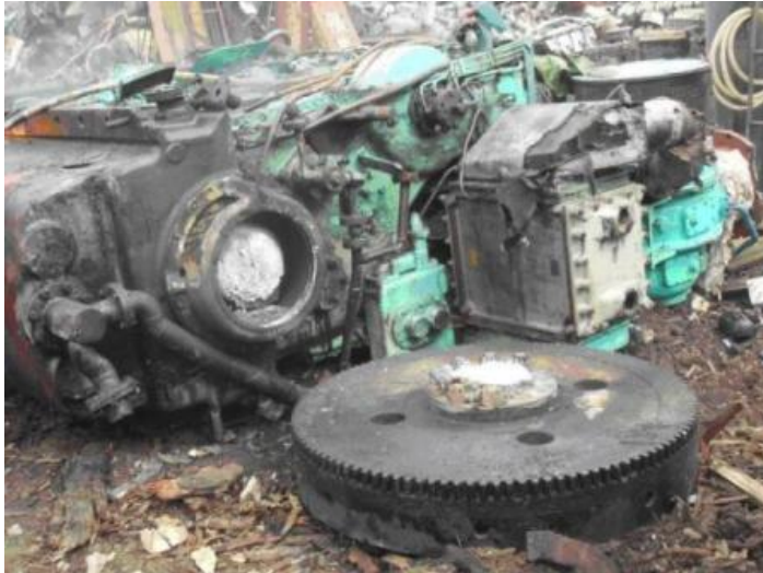
主機引擎曲軸切斷後
