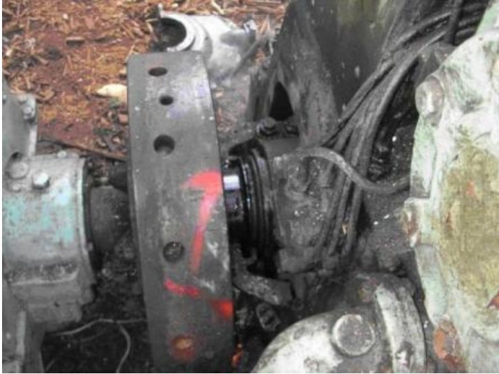
副機引擎曲軸切斷前
