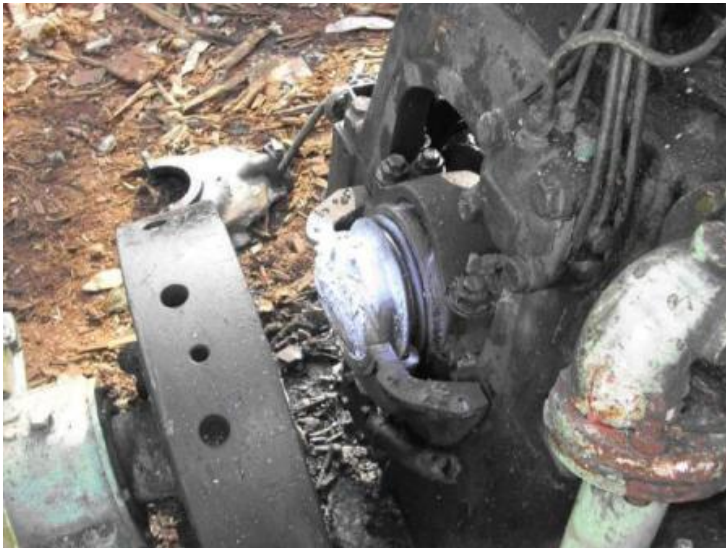
副機引擎曲軸切斷後
