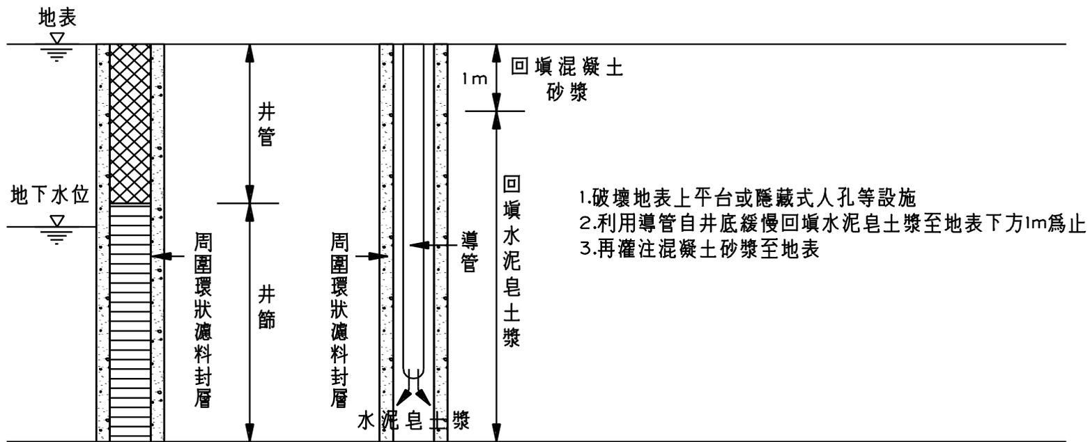
圖2 一般情形廢井作業示意圖
