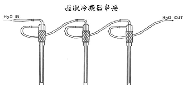
圖一 總氰化物蒸餾組裝示意圖
