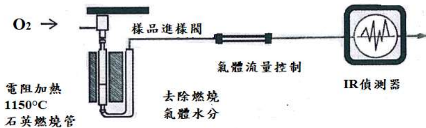
圖二 紅外線偵測含硫量測定儀：燃燒方法 B (1150°C)
